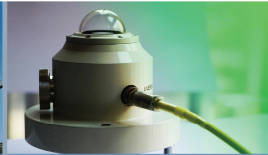
SPH5便携式光合有效辐射仪
