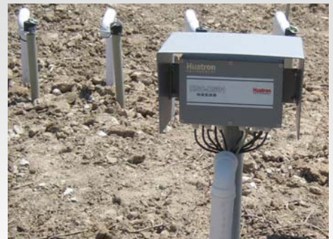
地温套管与土壤温度测量
