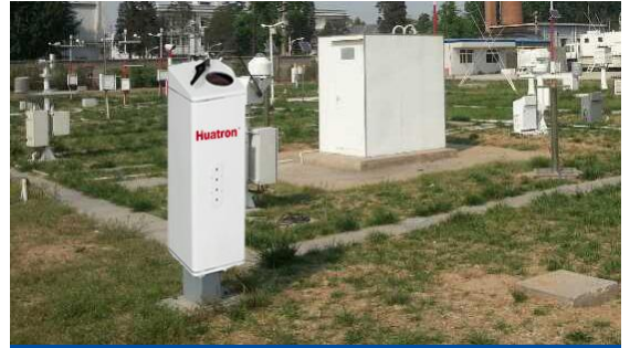
HC15 云高仪气象观测站观测
