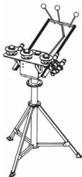
图3 将ASP50安装到三脚架上
