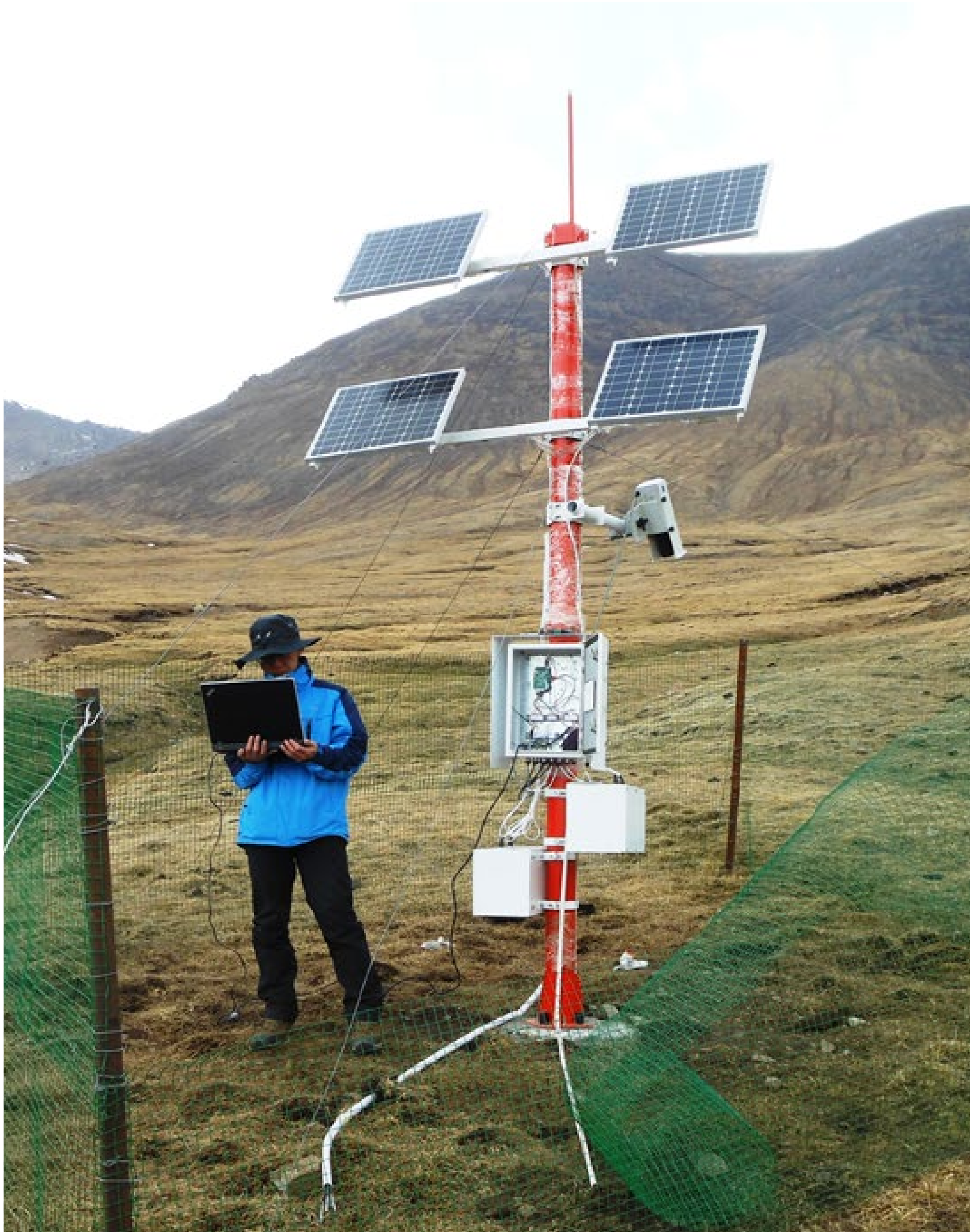
图为 MAWS860-SV 雪水储量站在天山进行雪深和积雪含水量测量，可以为“桃花汛”监测预警积累第一手资料。
