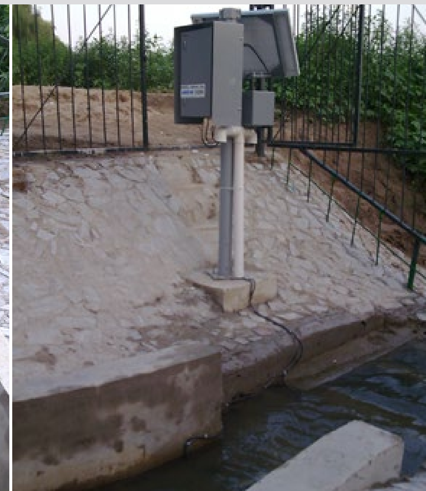
湿地进水口与出水口各安装一个，得出湿地流入水量、流出水量，监测湿地蓄水量变化。
